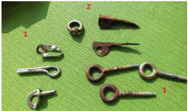
Nr.1: Deformierte Haken aus dem Zugversuch
