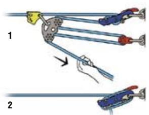
**B2 – Indirektes Flaschenzugsystem. Halbmastwurf mit Schleifknoten und separater Sackstichschlinge zum Abbinden.**
