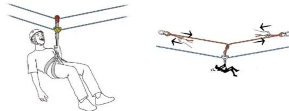
**E** Aufstieg an einer Seilrutsche. Verwende eine Umlenkrolle mit Seilklemme, um Kraft zu sparen.
