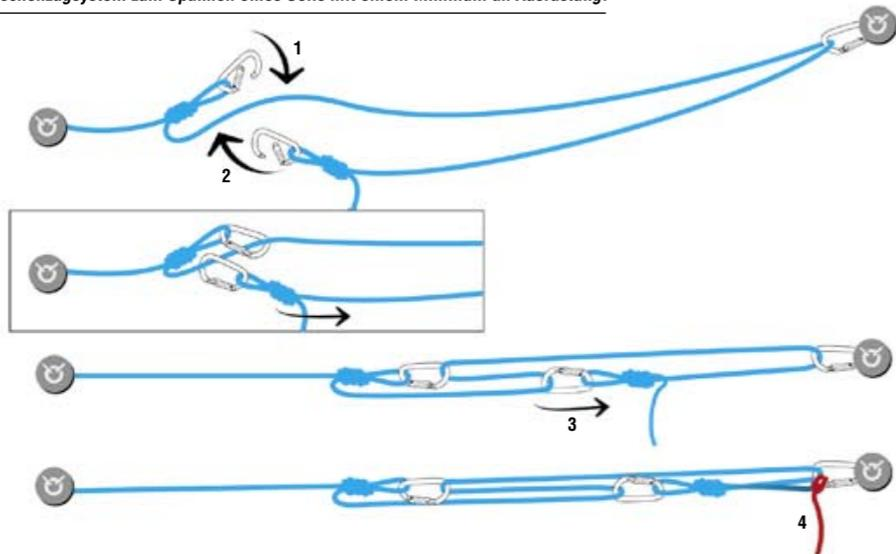
**B** Installation. Verwende ein halbstatistisches Seil gemäß EN 1891. Teste das System vor der Verwendung mit einem 100 kg-Sack oder fixiere ein Seil an der TANDEM-Rolle und ziehe es in der Mitte der Seilrutsche nach unten.
