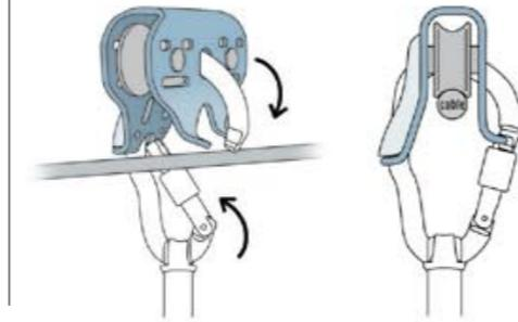
**C** Für Fortgeschrittene: Rückkehr zum Boden mithilfe eines STOP-Abseilgeräts.
