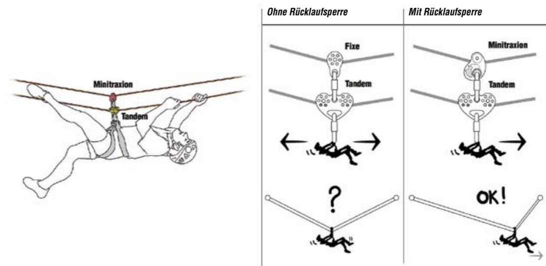
**F** Vorsichtsmaßnahmen: Verwende eine Rolle, die auf die Merkmale der Seilrutsche abgestimmt ist (z. B. Draht- oder Textilseil, Neigung).
